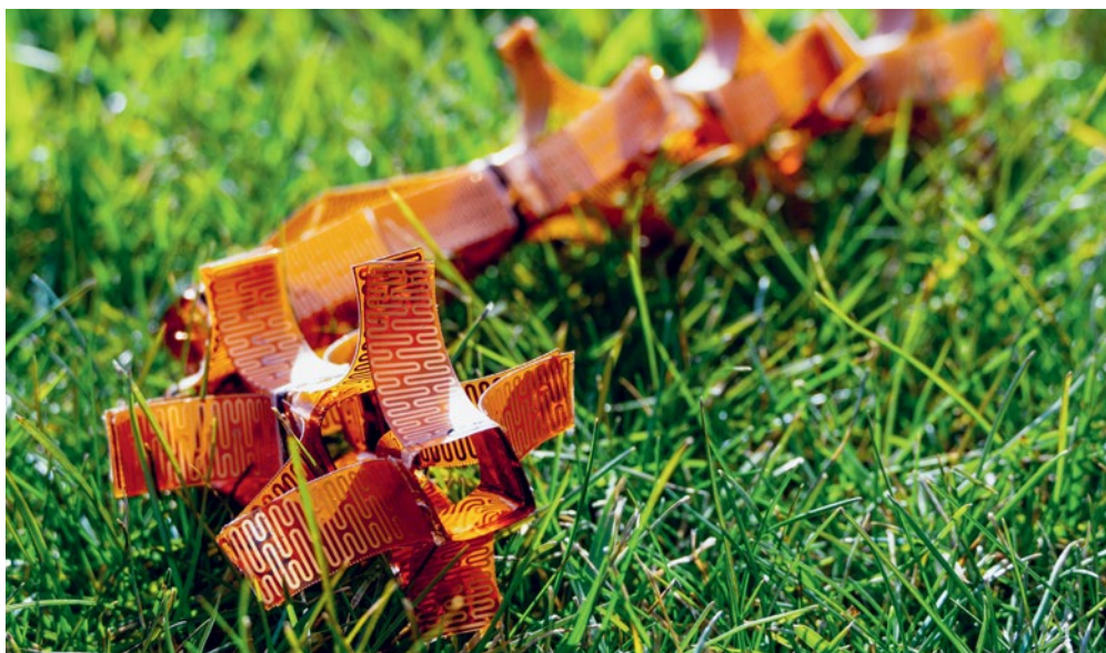
Ohne Motoren können sich diese Polymere durch Wärme biegen und dadurch bewegen. Foto: zVg
