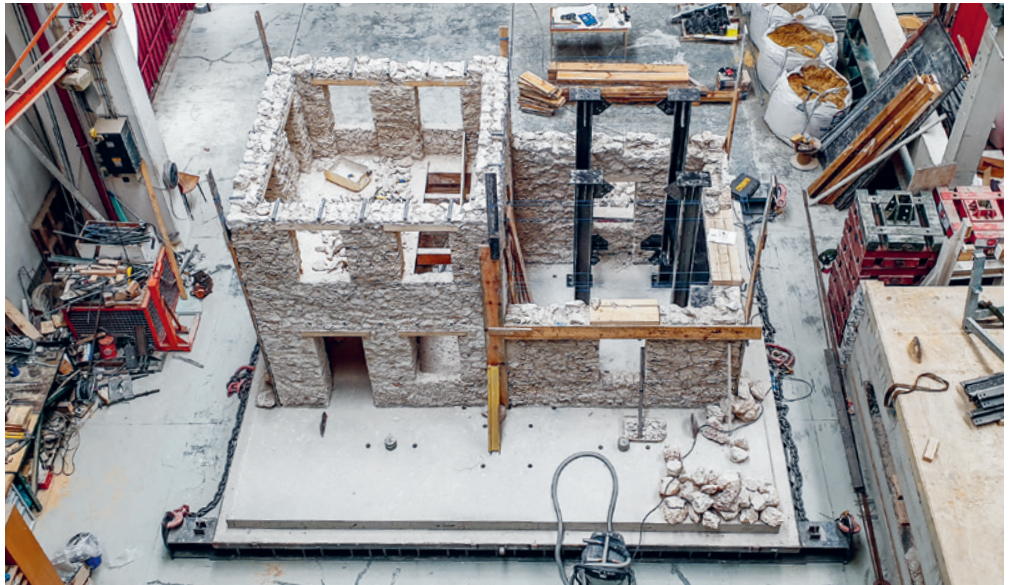
Ein Altstadtthaus wird für einen Erdbebenstest im Massstab 1:2 nachgebaut. Foto: I. Tomić/EPFL
