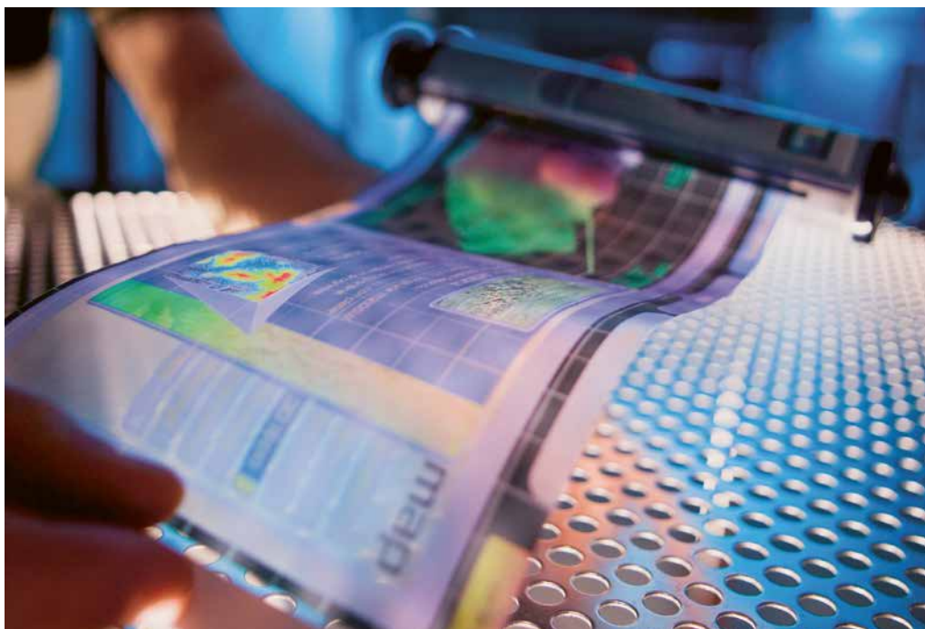
Les composants électroniques organiques permettent de fabriquer des écrans légers et flexibles, pratiques en déplacement. Photo: U.S. Army RDECOM/Wikimedia Commons
