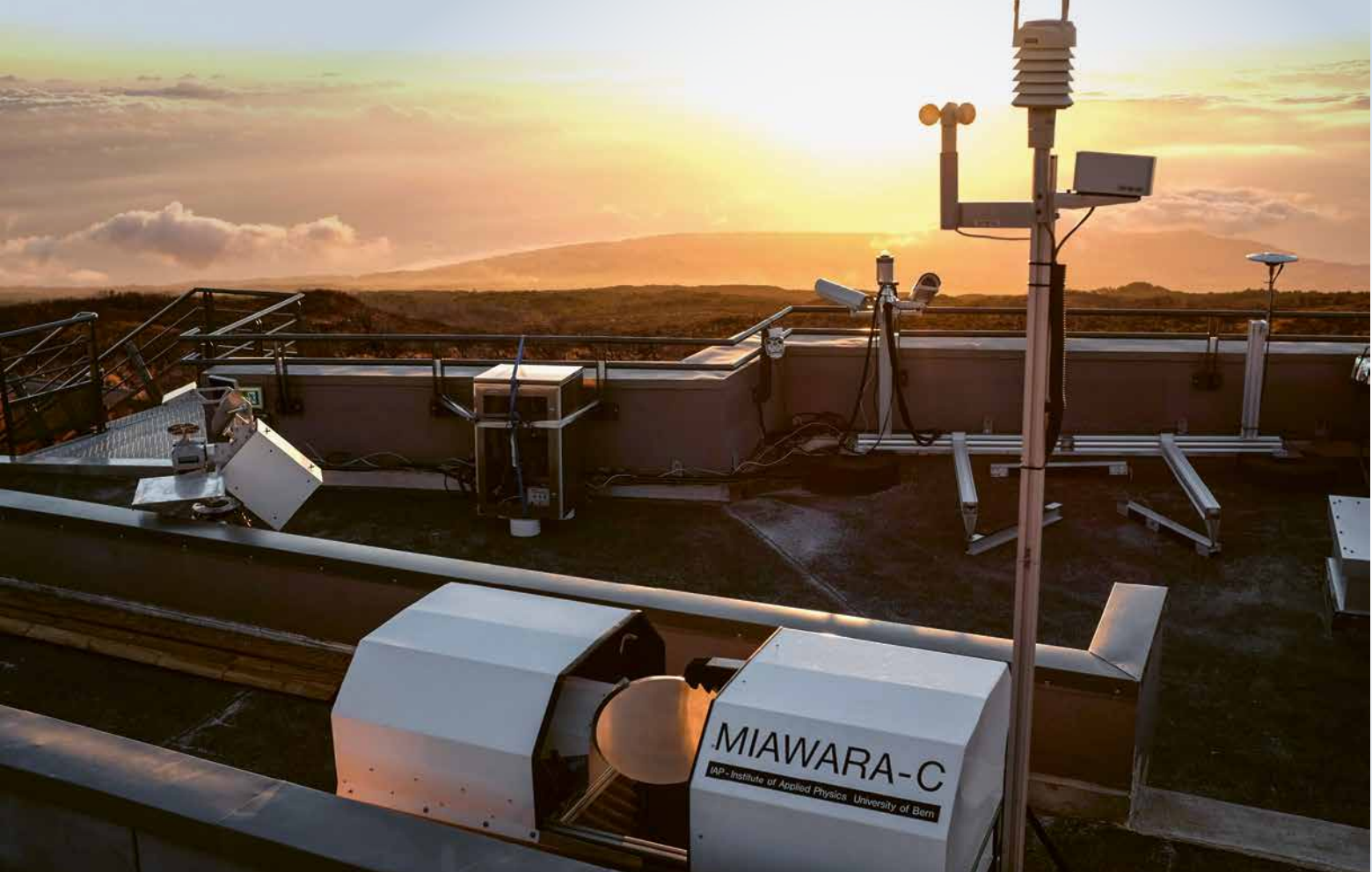
Un radiomètre micro-ondes de l'Université de Berne mesure la concentration en vapeur de l'atmosphère au-dessus de l'île de La Réunion, dans l'océan Indien. L'équipe bernoise utilise la même technologie en Suisse. Photo: Niklaus Kämpfer
