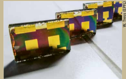
Prometteuses, mais encore au stade de prototype: des cellules photovoltaïques en pérovskite.
