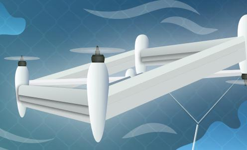
**Skypull** liebt die luftigen Höhen in 400 Metern und überträgt die Energie des Windes via ein Seil an einen Stromgenerator am Boden. Herkunft: ETH Zürich. Ein anderer Stromproduzent: Twingtec von der Empa, FHNW und ETH Zürich.
