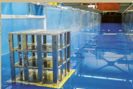
Est-ce que le bâtiment – modélisé par un cube percé d'ouvertures – résistera à la vague?
