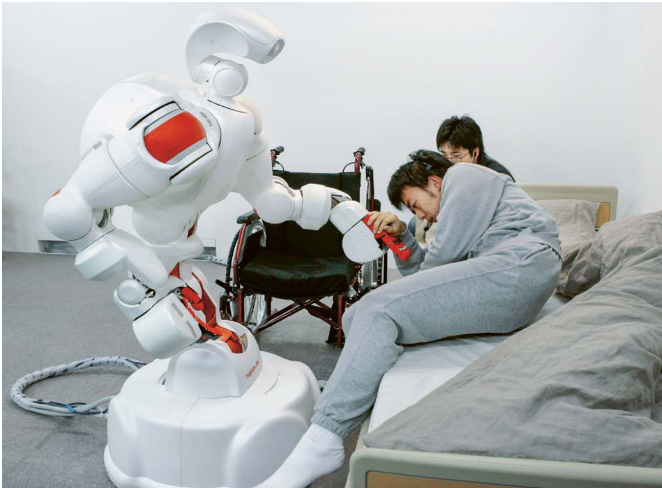
Der Pflegeroboter Twendy-One von der Waseda-Universität in Tokio demonstriert Sicherheit, indem er einem Studenten vom Bett in den Rollstuhl hilft. Bild: Keystone/AP Photo/Koji Sasahara
