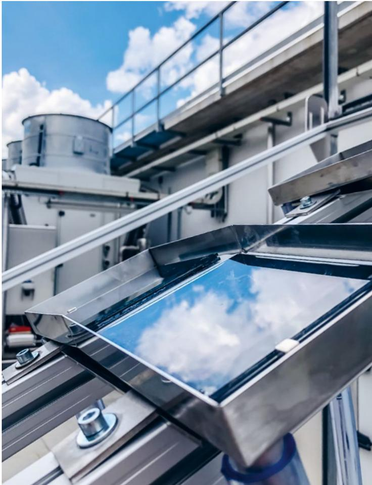
Auf dem Dach in Muttenz wird getestet, ob aus Solarzellen aus Perowskit Blei ins Regenwasser gelangen kann. Foto: zVg
